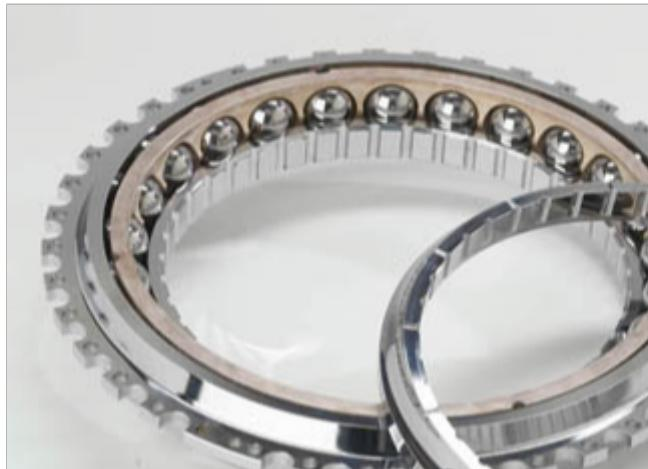
日常维护六，轴承的径向游隙越小越好吗？不是所有的轴承都要求小的工作游隙，您必须根据条件选用合适的游隙。国标4604-93中，滚动轴承径向游隙共分五组-2组、0组、3组、4组、5组，游隙值依次由小到大，其中0组为标准游隙。基本径向游隙组适用于一般的运转条件、常规温度及常用的过盈配合；在高温、高速、低噪声、低摩擦等特殊条件下工作的轴承则宜选用大的径向游隙；对精密主轴、机床主轴用轴承等宜选用较小的径向游隙；对于滚子轴承可保持少量的工作游隙。另外，对于分离型的轴承则无所谓游隙；轴承装机后的工作游隙，要比安装前的原始游隙小，因为轴承要承受一定的负荷旋转，还有轴承配合和负荷所产生的弹性变形量。浙江丝杠组合轴承售后无锡UNITEC轴承报告。
